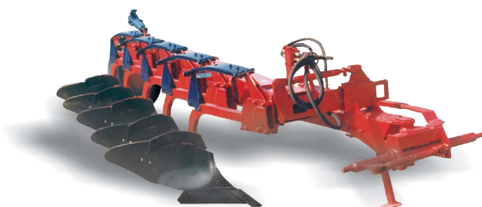
ПКМ-5-40P ПОЛУНАВЕСНОЙ для загонной вспашки
